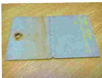
Figuur 2 Uitzicht probe na 4 maanden blootstelling aan een agressieve omgeving.
